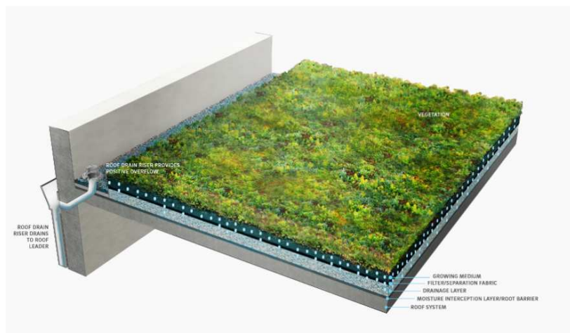
Figur 9 Figuren visar schematiskt uppbyggnad för ett grönt tak
